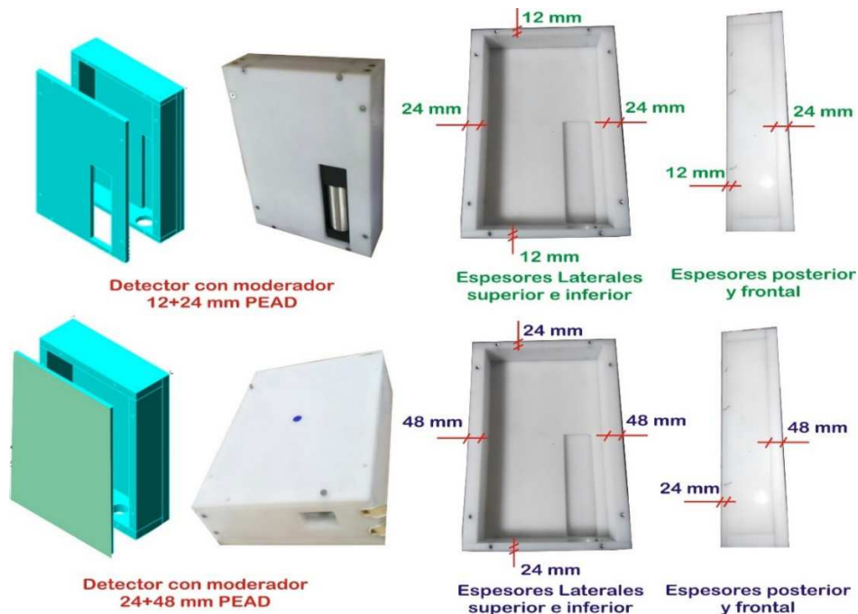
Figura4.- Moderadores de Polietileno de Alta densidad, PEAD 12+24 y 24+48 mm.
