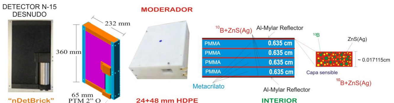
Figura 1. Configuración nDetBrick, interior exterior y moderador, construidos.
