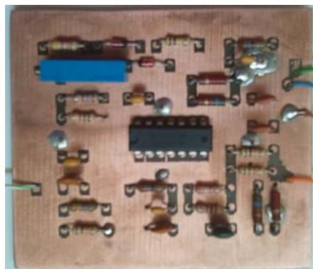
**Figura 9. Amplificador espectroscópico**
