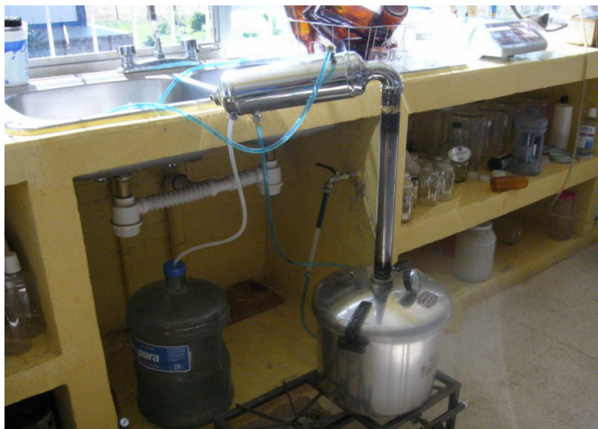
Figura 4. Proceso de extracción de aceite de alga por arrastre de vapor de agua.
