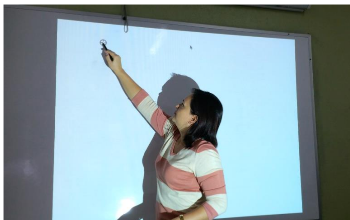
Figura 1. Se calibra con cuatro puntos, uno en cada esquina de la proyección
