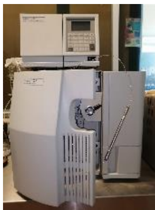
Figura 35. Detector UV-Vis Waters 2487 acoplado al HPLC Waters 1525 con una columna C8 instalada.
