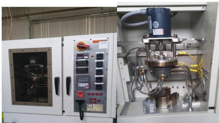
*Figura 12.- Fotografías del reactor CREC Riser Simulator. a) Panel frontal mostrando los controladores. b) Casquetes que contienen al reactor y recipiente que encierra a los casquetes.*
