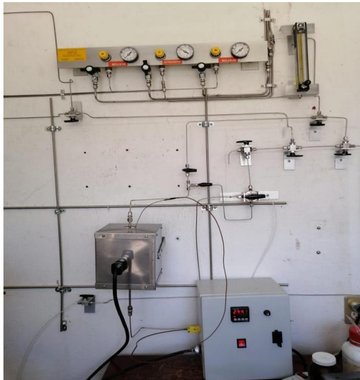
*Figura 10.- Reactor descomposición de isopropanol.*
