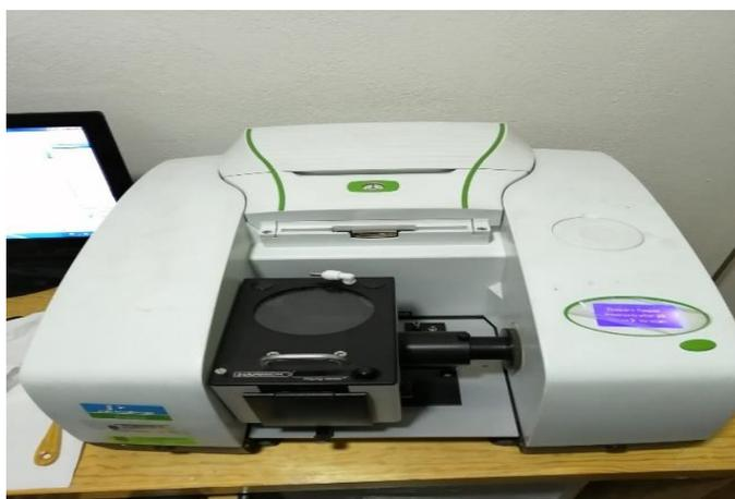
*Figura 11.- Fotografía del equipo Spectrum 3 MIR/NIR/FIR Spectrometer.*
