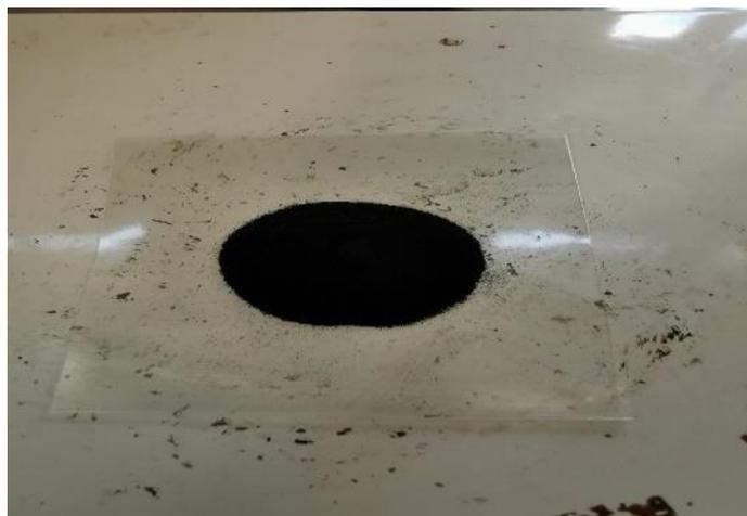
*Figura 20.- Catalizador reducido con hidrógeno de 5% Níquel promovido con 0.25%Ru-1%Mn.*
