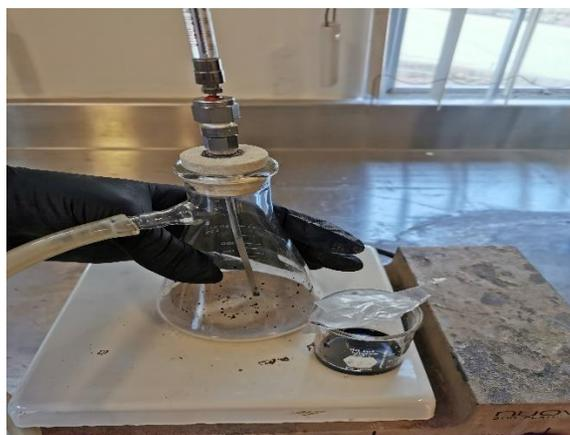
*Figura 6.- Proceso de co-impregnación de los metales sobre la gama alúmina ( $\gamma\text{-Al}_2\text{O}_3$ ).*
