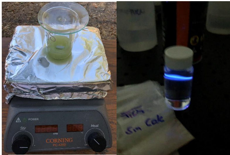
Figura 11. Síntesis de puntos cuánticos por proceso hidrotérmico.
