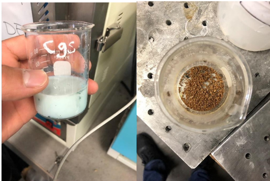
Figura 12. Síntesis de \text{WO}_3/\text{TiO}_2 por método sol-gel asistido por ultrasonido.
