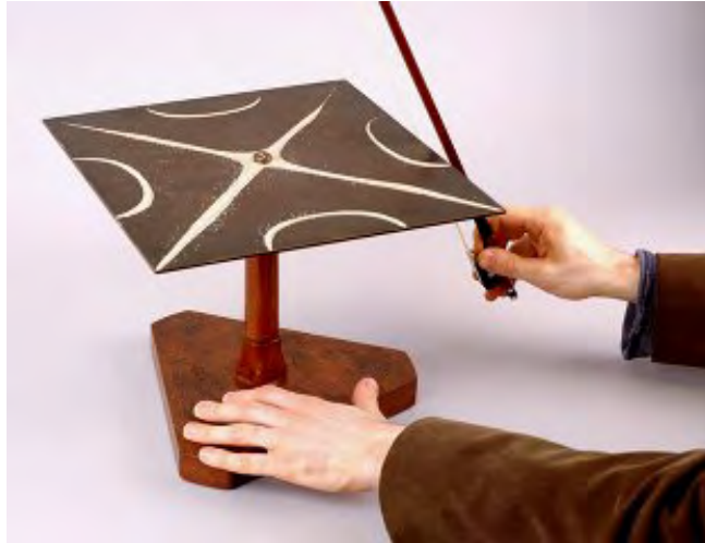
Figura 5. Método de Chladni para crear ondas estacionarias en una placa plana (Explore Whipple Collections, s.f.).
