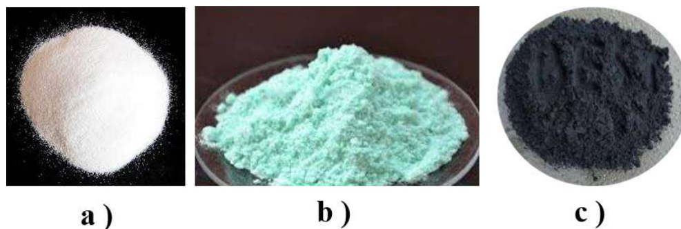
Figura 7. Pigmentación del soporte en las diferentes etapas de la síntesis de los catalizadores. Se muestran a) Alúmina gamma pura, b) Alúmina impregnada con el precursor del níquel y/o lantano o cerio y c) Alúmina con el precursor sometido al proceso de reducción.
