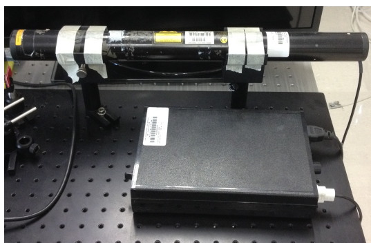
Figura 4.2 Láser He-Ne con \lambda = 543.5 .
