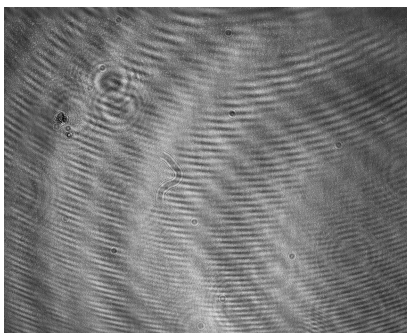
Figura 3.4 Holograma registrado a partir de la IHD con una apertura.
