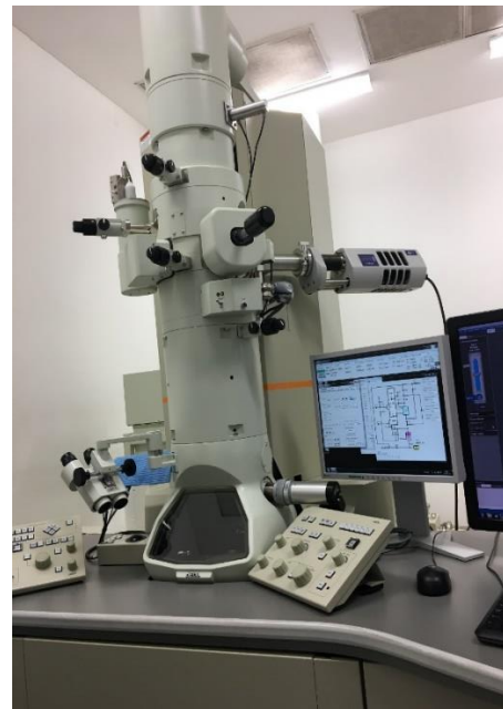
Figura 9. Joel-Jem-2100 para tomar micrografías por TEM.
