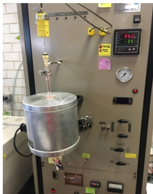
Figura 6. Reactor de reacción para TPR y TPD acoplado con un TCD.
