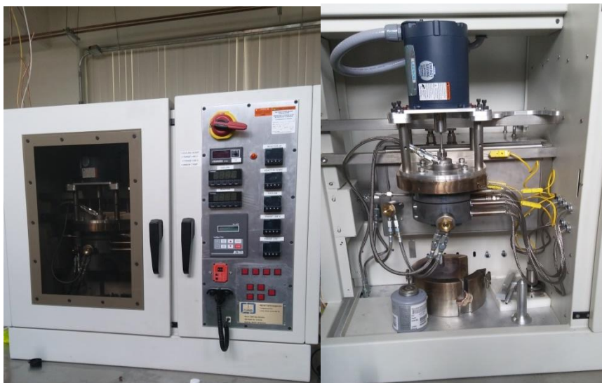
Figura 12. Fotografía del reactor: a) vista frontal del reactor CREC Riser Simulator (b) vista interior del reactor.
