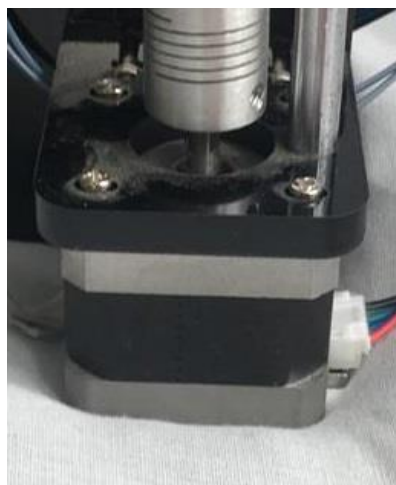
Figura 2.22. Ejemplo de motor de impresoras 3D
