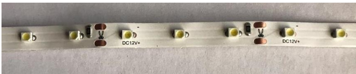
Figura 3.19. Tira LED utilizada para iluminación
