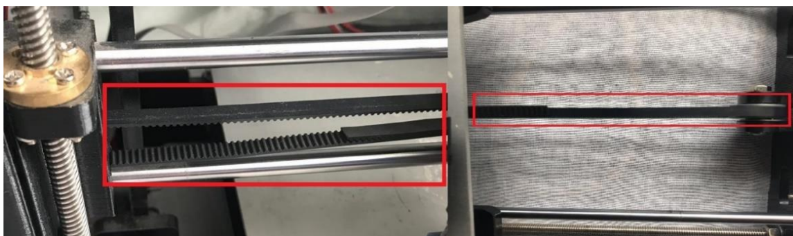
a) b) Figura 2.30. Correas; a) en eje X, b) en el eje Y
