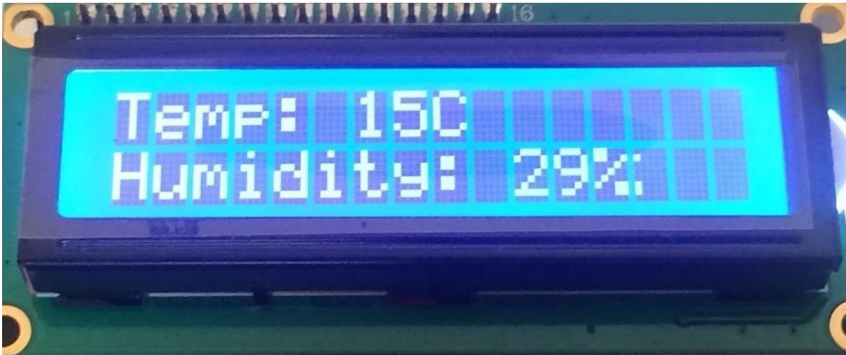
Figura 4.15. Pantalla LCD mostrando los datos de sensor DHT11
