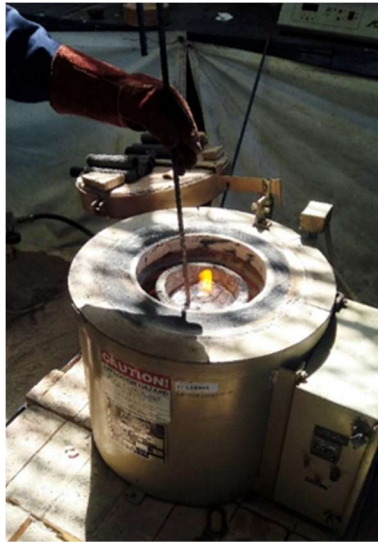
Figura 4.5 Fundición de aleación 380 en horno de resistencia, la adición de Li provoca una ligera combustión.
