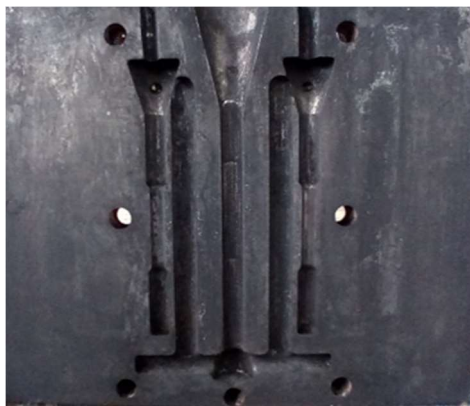
Figura 4.7 Interior del molde metálico recubierto con grafito.
