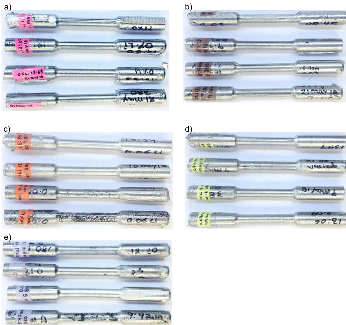
Figura 4.9 Probetas obtenidas de la fundición. a) 380, 0 % Li, b) aleación A, c) aleación B, d) aleación C, e) aleación D.
