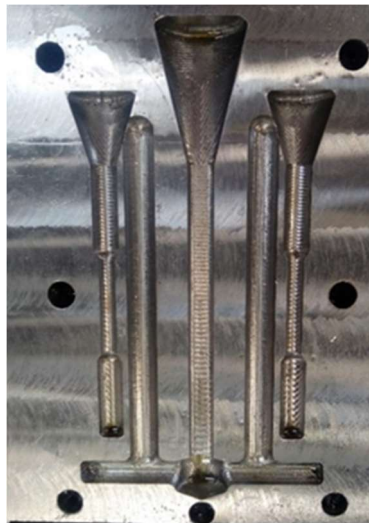
Figura 4.2 Molde de acero AISI/SAE 1020 maquinado de acuerdo a norma B 108-03 [39].
