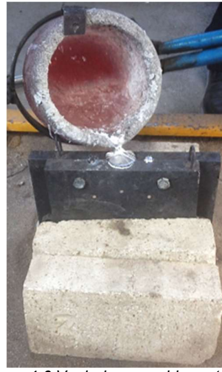
Figura 4.6 Vaciado en molde metálico.
