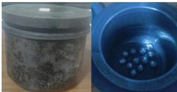
Figura 24. *Contenedor utilizado en el molino planetario. A la derecha se observa el recipiente con polvo y bolas molidoras.*
