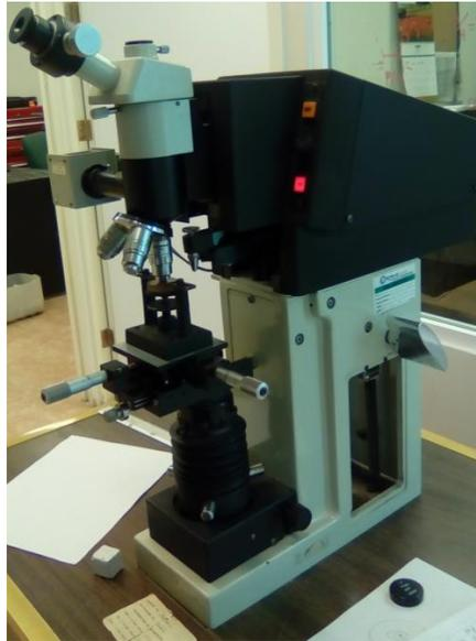
Figura 28. *Equipo de medición de microdureza Wilson.*
