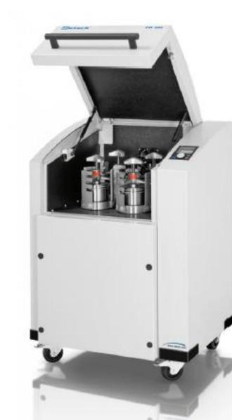
Figura 25. *Molino planetario RETSCH PM 400 utilizado en el aleado mecánico.*
