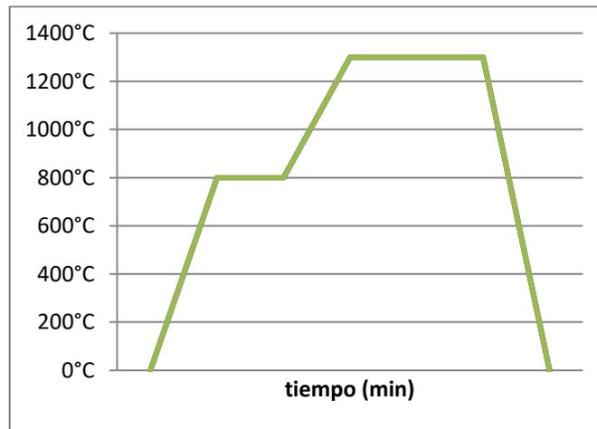
Gráfica 1. *Rampa de calentamiento empleada para la sinterización de los materiales compuestos fabricados.*
