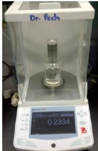
Figura 27. Balanza analítica. En su interior, kit de medición de la densidad.
