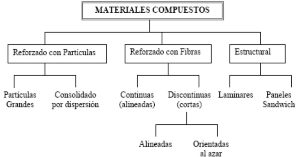
Figura 7. Clasificación de los materiales compuestos según la naturaleza del refuerzo. (6)
