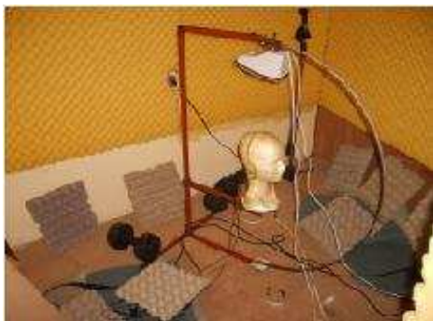
Figura 5. Montaje del equipo en la cabina: Estructura metálica graduada en azimuth y elevación, maniquí y bocina.
