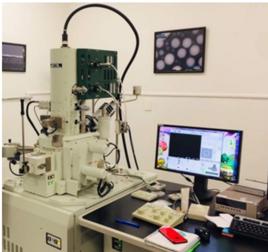
Figura 3.15 Microscopio electrónico de barrido, marca JEOL JSM-7800F, donde se observaron las películas de titanía con clorofila.
