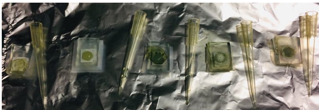
Figura 3.8 Electrodo de titania sensibilizados por pipeteo del colorante con diferentes solventes.
