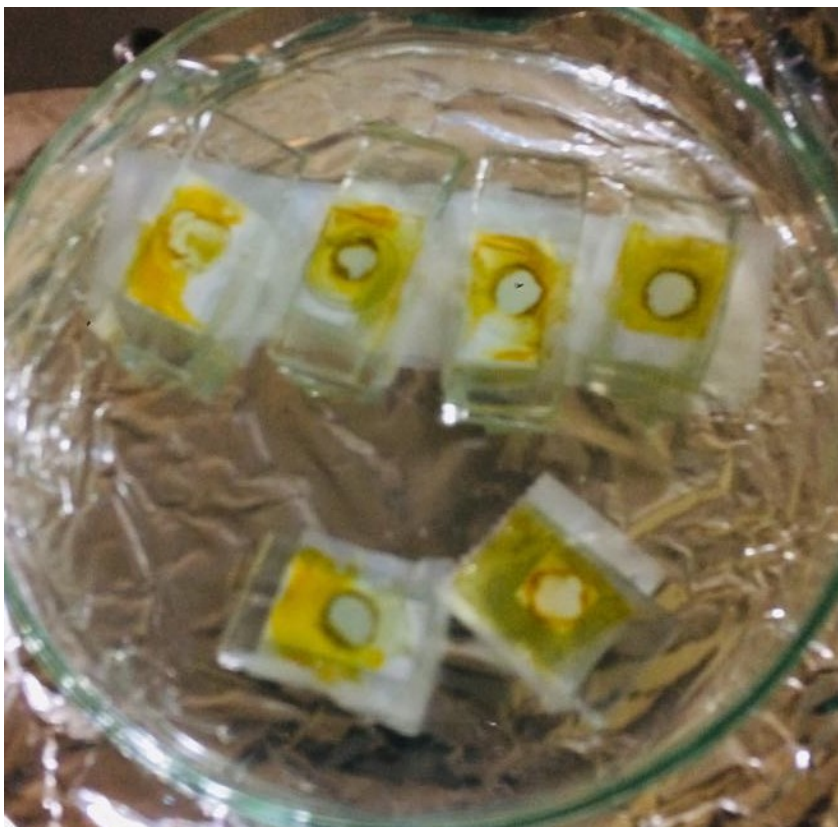
Figura 3.12 Depósito de electrolito sobre el electrodo enmascarado.
