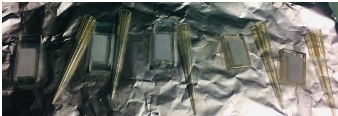
Figura 3.7 Foelectrodos enmascarados, listos para la sensibilización por pipeteo de colorante con diferentes solventes.
