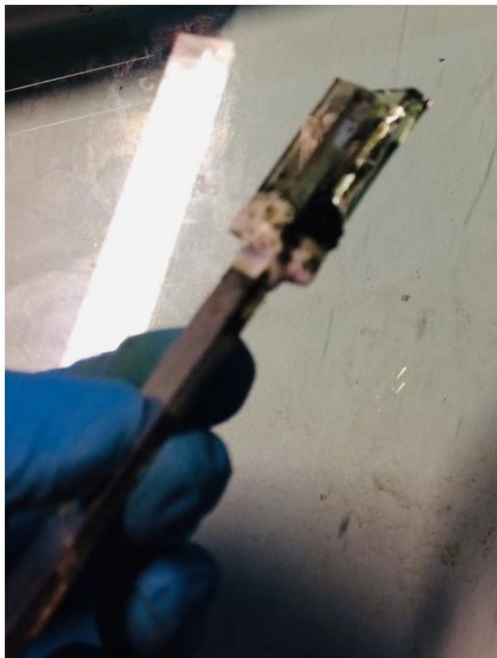
Figura 3.9 Ensamblaje de electrodos en tira de aluminio.
