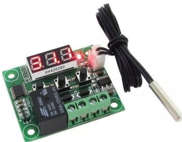
Figura 3.4 Módulo de control de temperatura, con termopar tipo K y relevador de activación de foco incandescente, como fuente de calor
