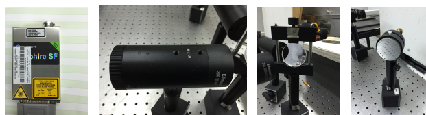
(a) Laser (b) Expansor (c) Divisor (d) Espejo
