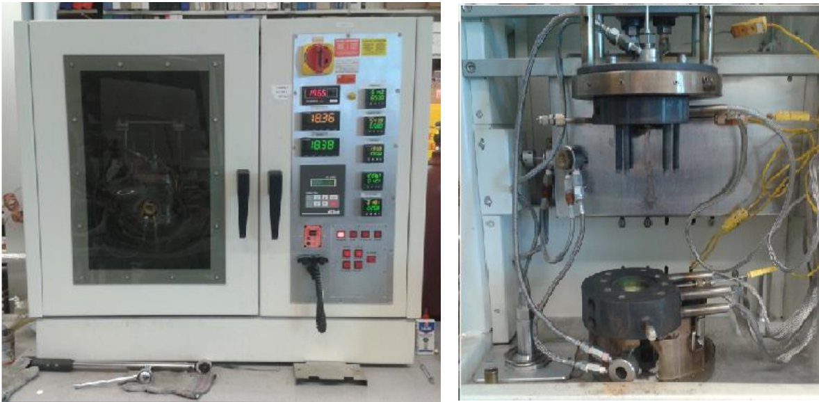
Figura 3.3. a) Reactor CREC Riser Simulator, vista frontal, b) Reactor CREC Riser Simulator, abierto.
