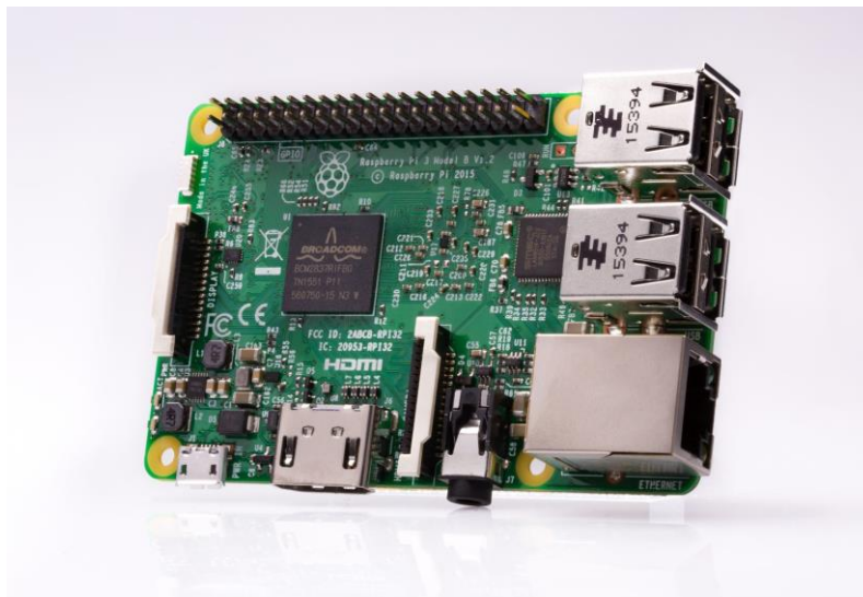
Figura 11. Versión Raspberry 3Pi utilizada en los experimentos [57].
