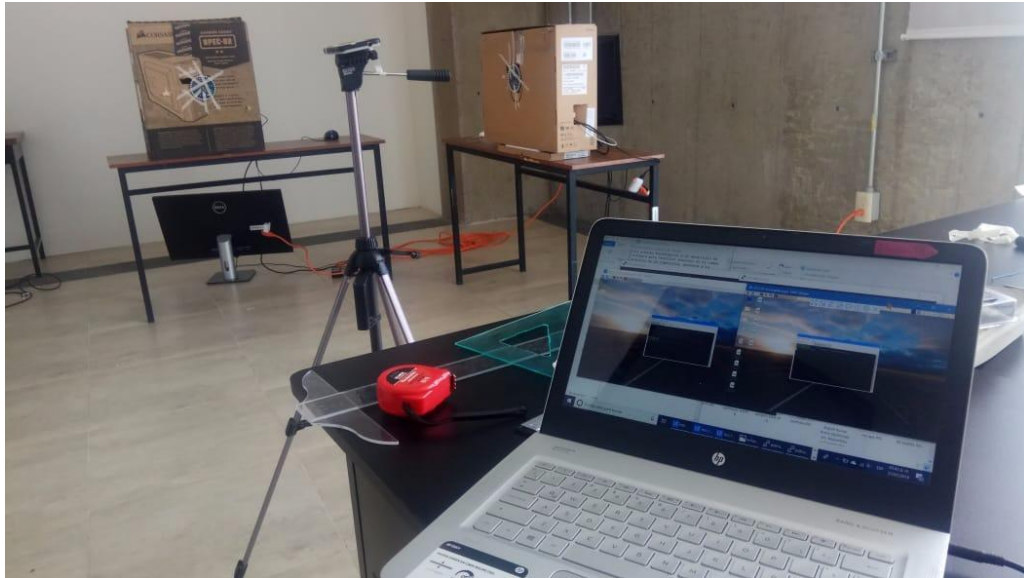
Figura 16. Se colocó un tripoide con coordenadas medidas a cada arreglo de micrófonos en las cajas A y B con respecto a la fuente emisora (tripoide).
