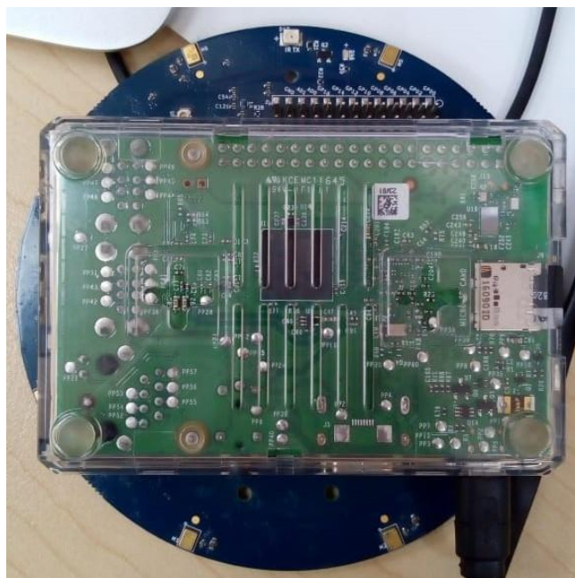
Figura 13. Vista de la parte posterior de la tarjeta de desarrollo Matrix Creator conectada a Raspberry 3 Pi.
