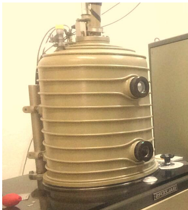
Figura 4.16 Evaporador térmico. Cámara del evaporador térmico. En la parte inferior (mesa negra) se encuentra una bomba mecánica y una bomba de difusión, mecanismos que permiten generar presiones de vacío dentro de la cámara.
