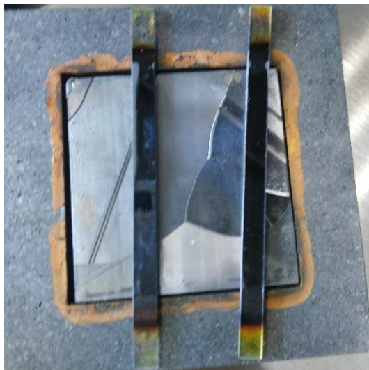
Figura 4.9 Placa de grafito, con la pastilla sólida de CdTe y sobre ellos los separadores de cuarzo de 1 mm.
