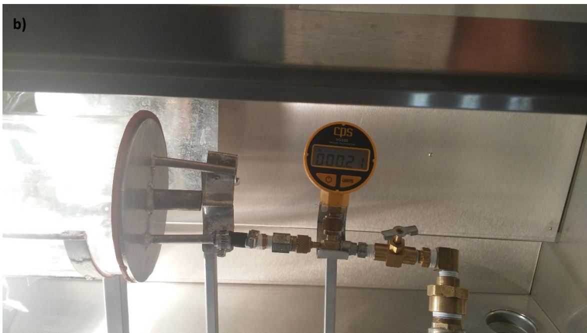
Figura 4.11 Reactor de CSS. a) Reactor de sublimación en funcionamiento. b) Reactor en función luego de 10 minutos de operación se observa una presión de 0.21 torr.
