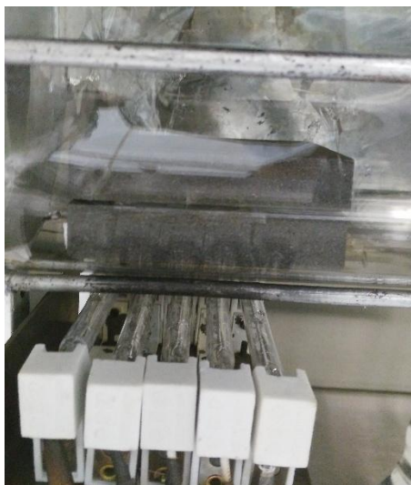
Figura 4.10 Placas de grafito dentro del reactor de cuarzo.
