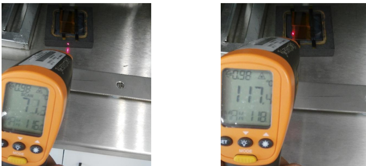
Figura 4.12 Diferencia de temperatura existente en el interior de la placa de grafito y su superficie.
