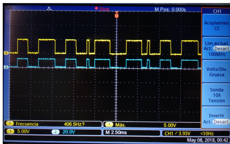
Figura 4.12 Comparación entre una señal de pulsos del PIC16F877A y la señal de disparo de un IGBT.
