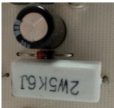
Figura 4.8 Fuente reguladora de voltaje con diodo zener - Tercer puente H
