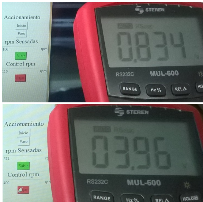
Figura 4.5 Relación entre la velocidad y el voltaje.
