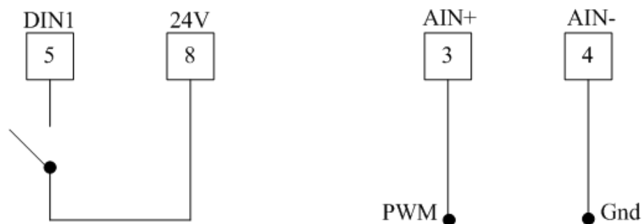
Figura 4.1 Conexiones a puertos del Micromaster 420.
