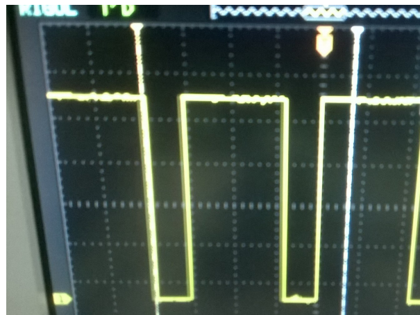
Figura 3.4 Respuesta del sensor de efecto Hall.
