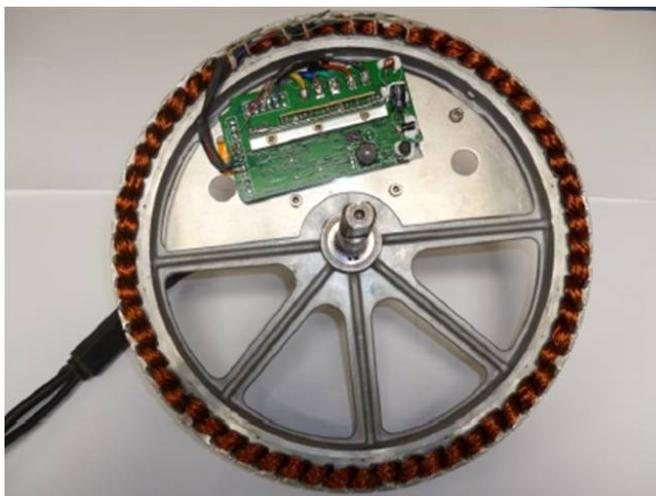
Figura 2.7 Estator del motor BLDC.
