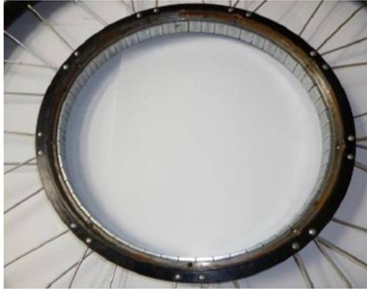
Figura 2.11 Rotor del motor Magic Pie BLDC.
