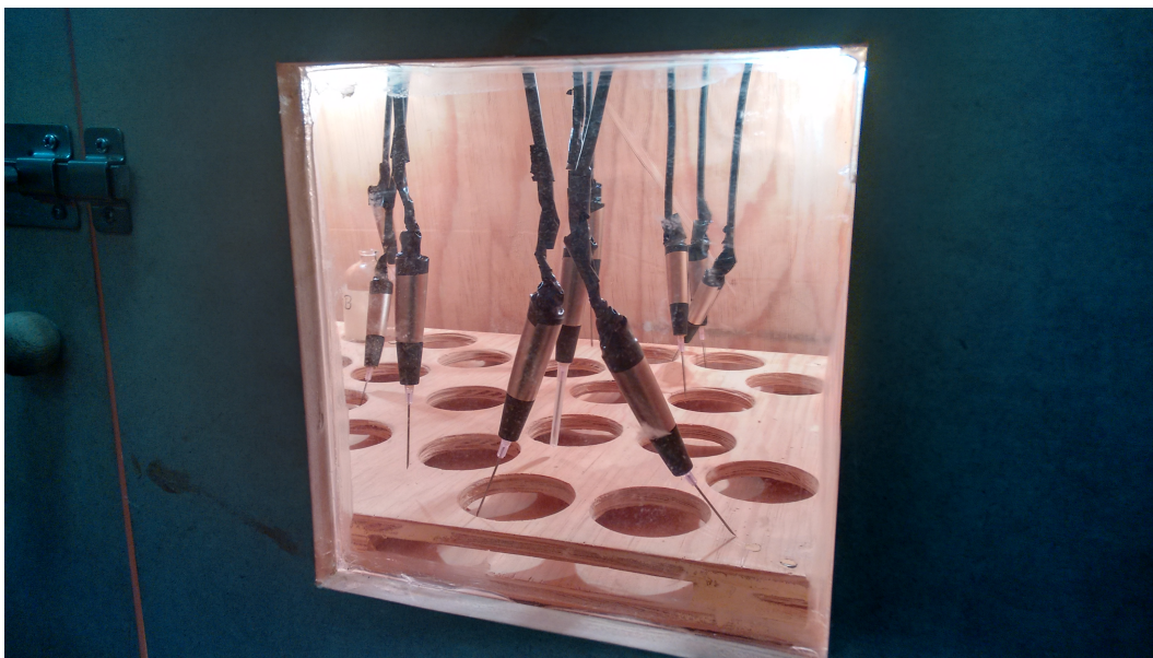
Figura 3.20 Pruebas del control de temperatura con la cámara cerrada.
