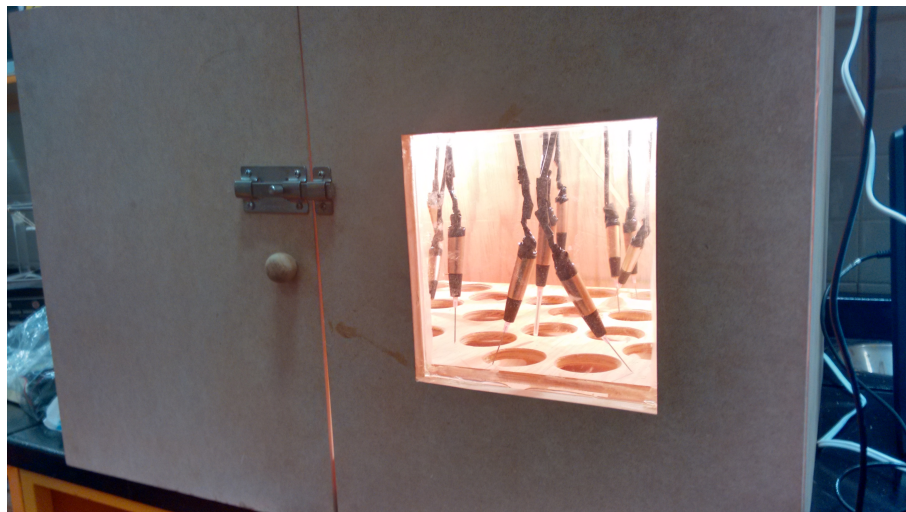
Figura 3.15 Pasador y cámara cerrada para no dejar escapar el calor generado por los focos.
