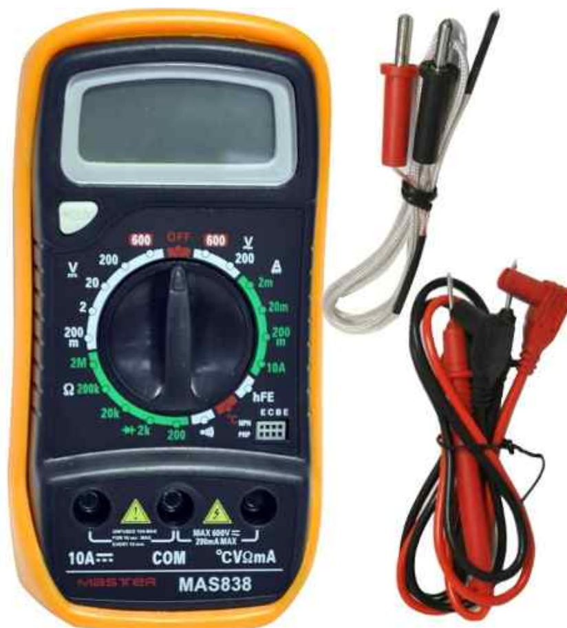
Figura 3.16 Multímetro digital usado para checar la temperatura del interior de la caja.
