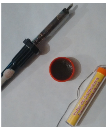
Figura 3.11 Cautín, soldadura y pasta usados para soldadura de sensores.
