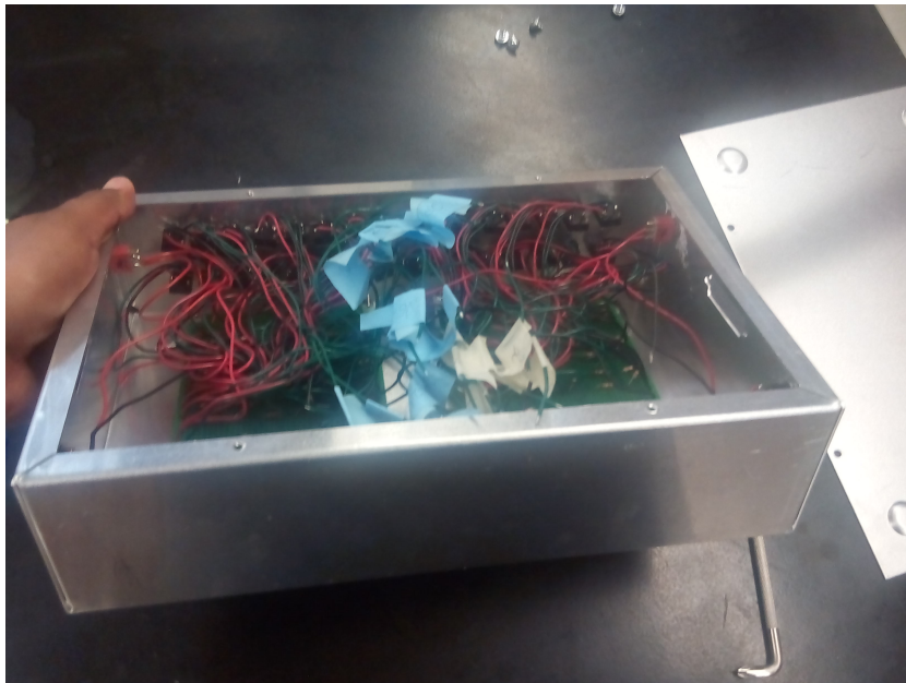
Figura 1.10 Conexiones de cables del divisor de voltaje.
