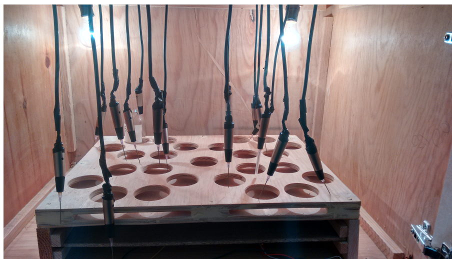
Figura 2.7 Sensores de presión sin conectar dentro de la cámara.
