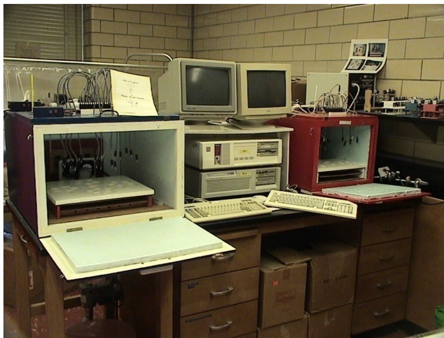
Figura 1.1 Cámaras computarizadas de producción de gas desarrolladas en la Universidad de Cornell, Ithaca, NY.
