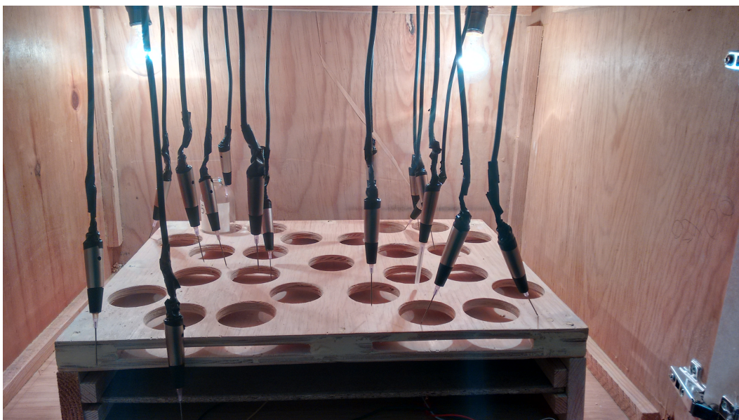
Figura 2.10 Cámara de fermentación: se observan los focos de 100 W en la parte trasera de la cámara.
