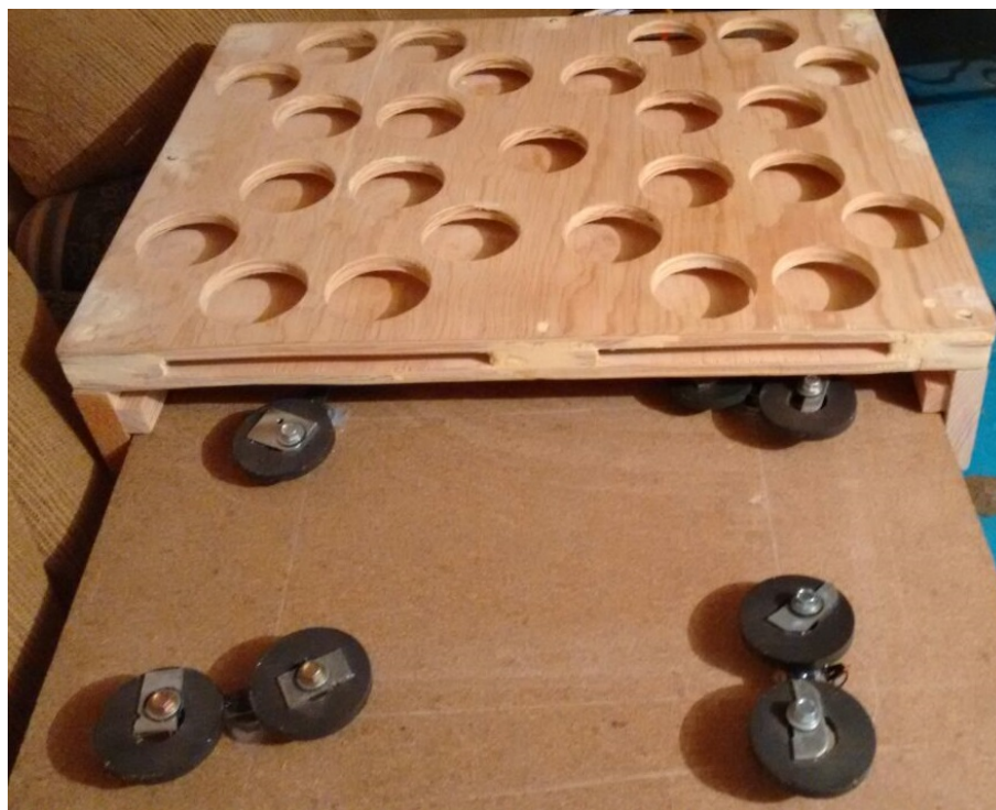
Figura 3.9 Unión imanes-motores montados en su base, y contenedora para los frascos de prueba Wheaton.
