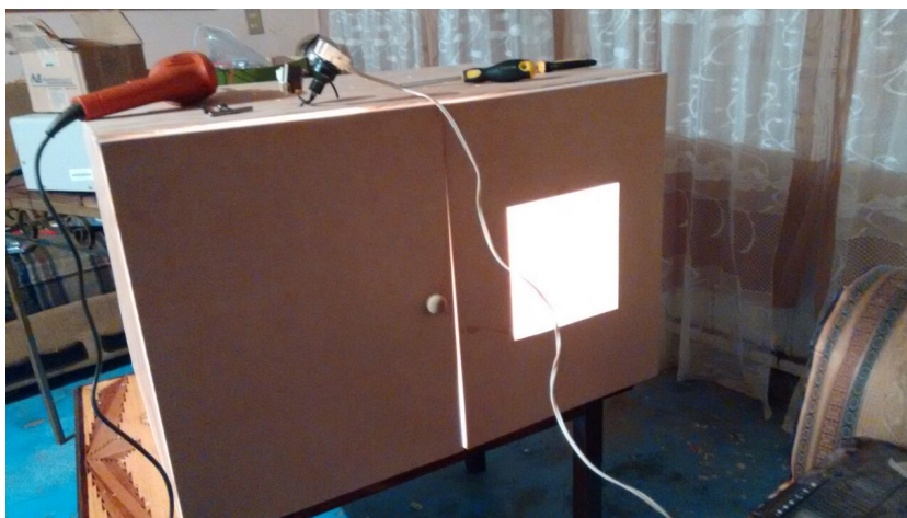
Figura 3.5 Colocación de la puerta y perforación de la cámara.
