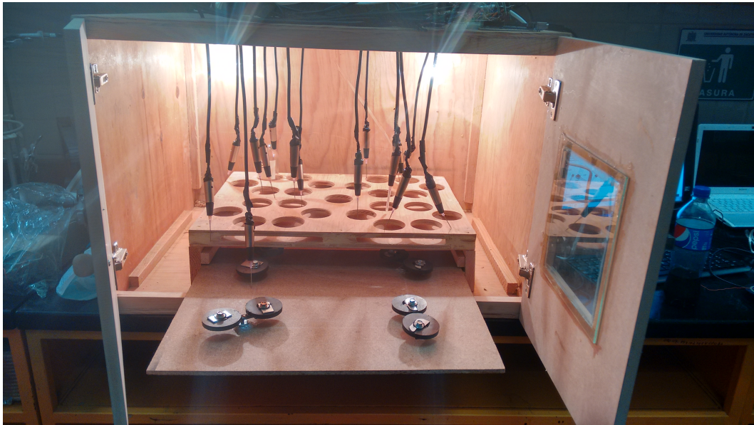
Figura 2.6 Imanes montados en los motores, mostrados dentro de la cámara.
