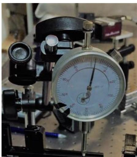
Figura 4.8 Desplazamiento de 10000 pasos dando dos revoluciones y 2 subdivisiones en sentido horario.
