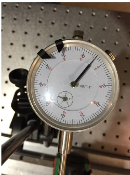
Figura 4.7 Desplazamiento de 1792 pasos dando 4 subdivisiones en sentido anti horario.
