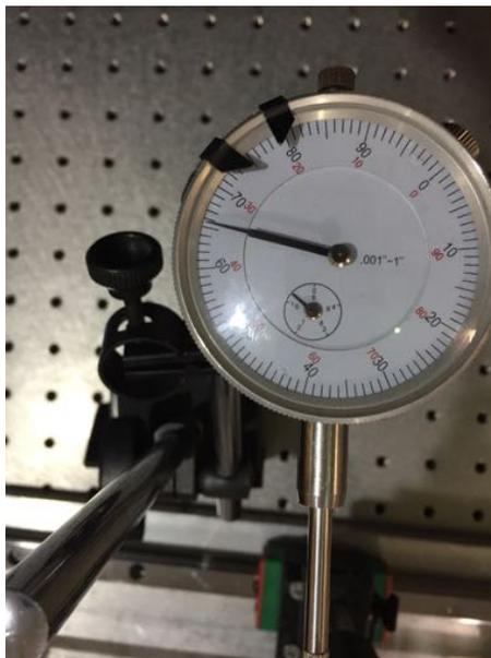
Figura 4.6 Desplazamiento de 10000 pasos dando 34 subdivisiones en sentido anti horario.
