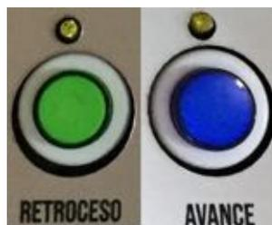
Figura B.3 Switch indicadores de direccion.
