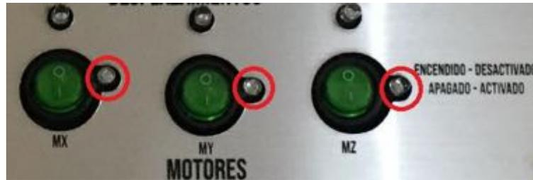
Figura B.8 Leds indicadores de la deshabilitación de los motores.
