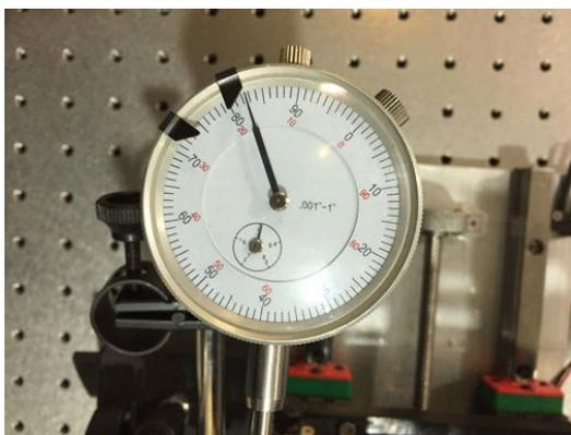
Figura 4.3 Desplazamiento de 10000 pasos dando una revolución y 118 subdivisiones en sentido anti horario.
