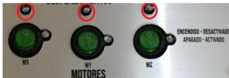
Figura B.5 Leds indicadores de motores.
