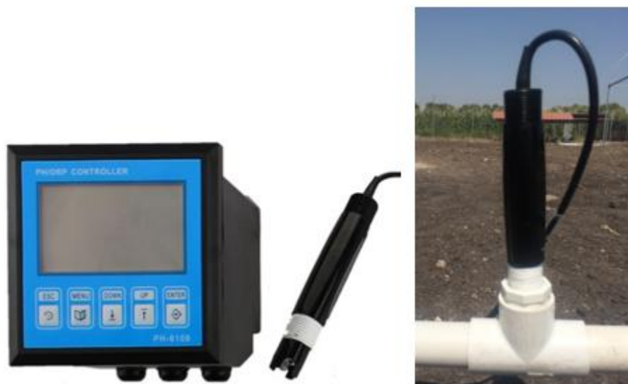
Figura 3.9 Sensor de pH utilizado en línea
