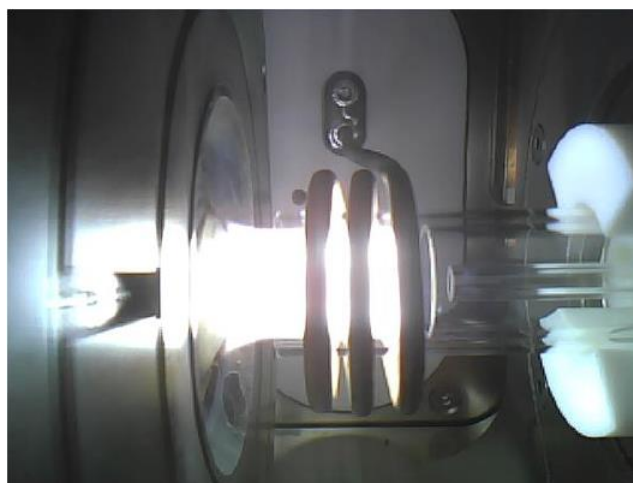
Figura 6.- Fuente de Iones e interface ICP (A), Vista real del plasma integrado en una cámara (B).
