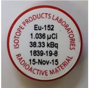
FIGURA 28. Fuente radiactiva de europio-152.
