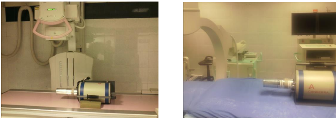
FIGURA 48. Fluoroscopia y rayos X del detector GeRe-3522.
