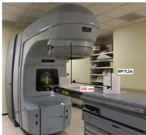
Figura 6.- Medición de la  $H^*(10)$  con el MP/TLDs en el LINAC de 15 MV.
