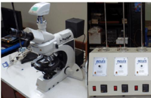
Figura 3: Instrumentación necesaria para el procesamiento de datos luego de la exposición de los detectores a una fuente de neutrones; son un baño María un microscopio óptico, solución química de  $\text{KOH}$ .
