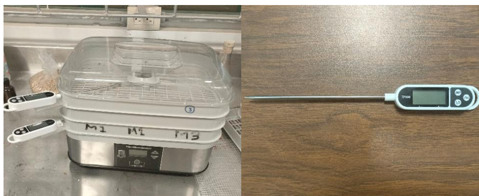
Figura 30. Secador por aire caliente con termómetros en cada bandeja
