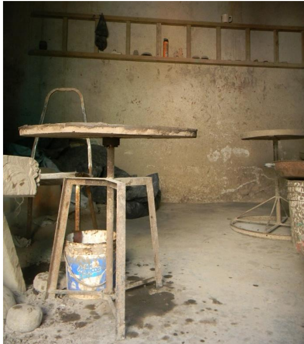
Imagen 32. Tornos usados para hacer cántaros y ollas
