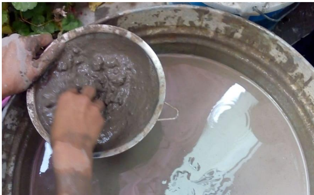
Imagen 21. Proceso de preparación de barro colado
