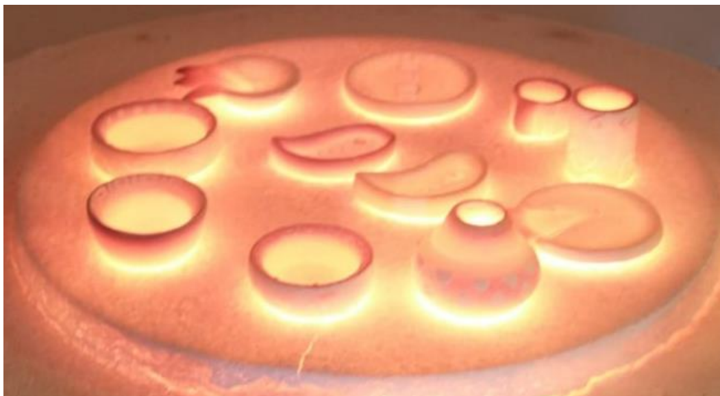
Imagen 26. Incandescencia que se observa cuando ha subido la temperatura en un horno
