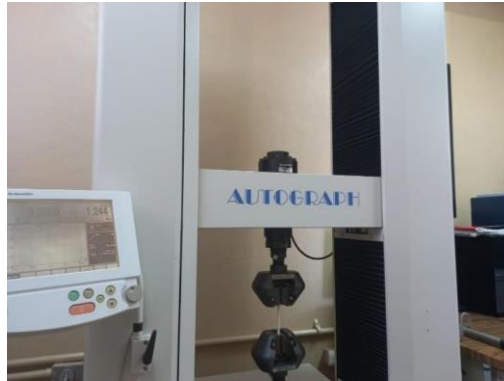
Figura 20: Máquina Universal de Ensayos AUTOGRAPH-I. Elaboración propia.
