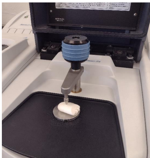
Figura 23: Equipo de FTIR con accesorio de reflectancia total atenuada ATR
