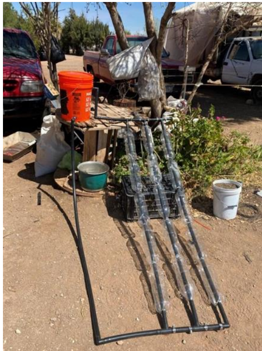
Imagen 10. Producto final. La ecotecnia el boiler solar, en funcionamiento
