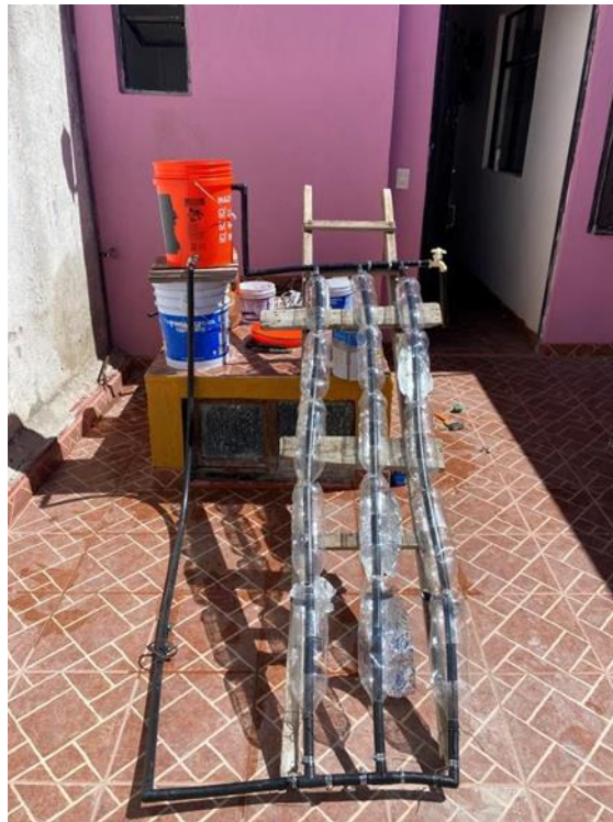
Imagen 5. Prototipo de la ecotecnia el boiler solar
