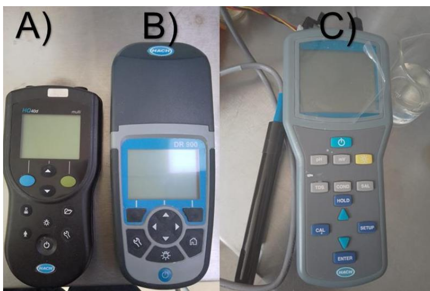
Figura 3.57 Equipos de laboratorio. A) pH-HACH HQ40D, B) Turbiedad-HACH DR900, C) C.E.-HACH H170.
