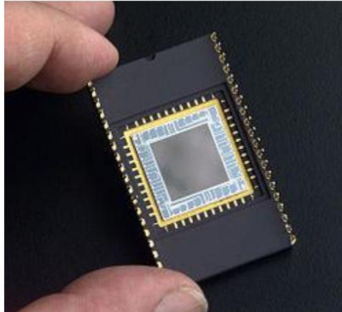
Fig. 1.6 Sensor CCD
