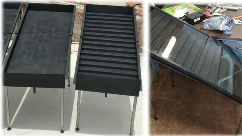
*Figura 38. Estructuras de equipo de regeneración: a) cubierta de pintura de esmalte, b) cubierta de vidrio.*
