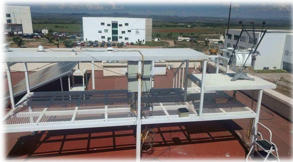
*Figura 255 Estación Solarimétrica Zacatecas\_04 del Sistema Nacional de Solarimetría.*
