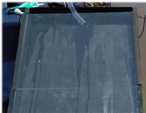
*Figura 55. Canalización en el flujo de solución de  $\text{CaCl}_2$ .*
