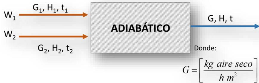
Figura 11. Cámara de mezcla adiabática.
