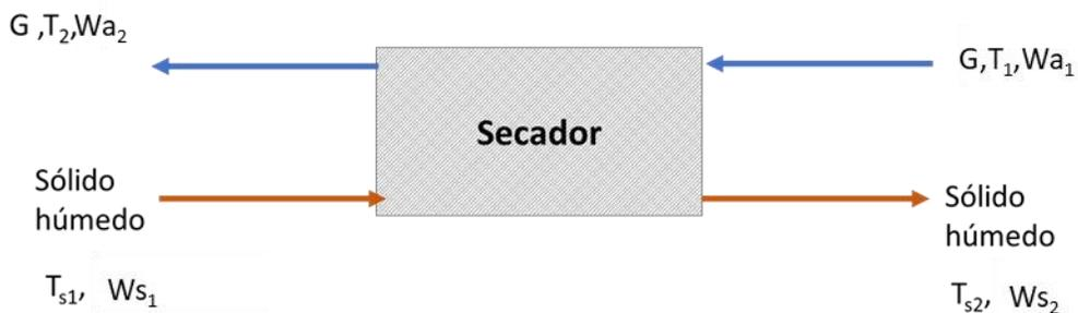
Figura 15. Humidificación entre sólido y gas.
