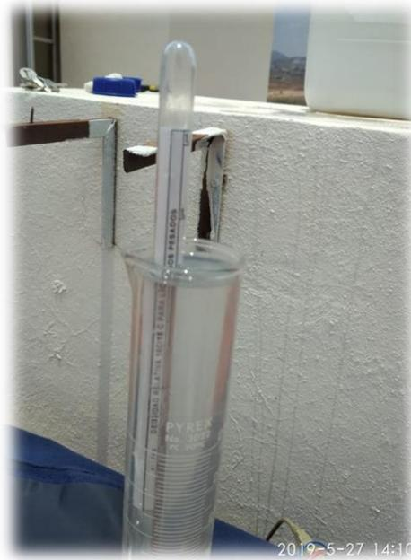
Figura 53. Determinación de densidad relativa en soluciones de  $\text{CaCl}_2$  con densímetro.
