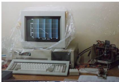
Prueba preliminar, en casa de Zacatecas, del medidor automático de ganancia y fase en un filtro pasa bajas. El sistema electrónico está a la derecha.
