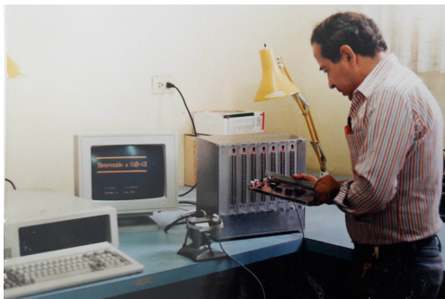
SAD-GE completo para 64 canales; al fondo, pantalla de bienvenida, al centro, gabinete con 7 módulos analógicos y Raúl con un módulo analógico en mano.
