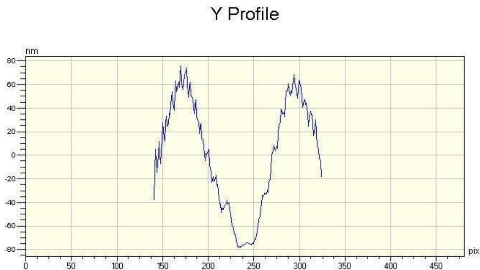
Figura 4.16: Vista transversal a lo largo del eje y del perfil de las aberraciones en el espejo de pruebas obtenido por el análisis interferométrico.
