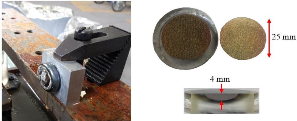
Figura 3-3. Montaje de las muestras en máquina electroerosionadora para seccionarlas, obteniendo dos partes con un diámetro aproximado de 25mm y espesor de 4mm.
