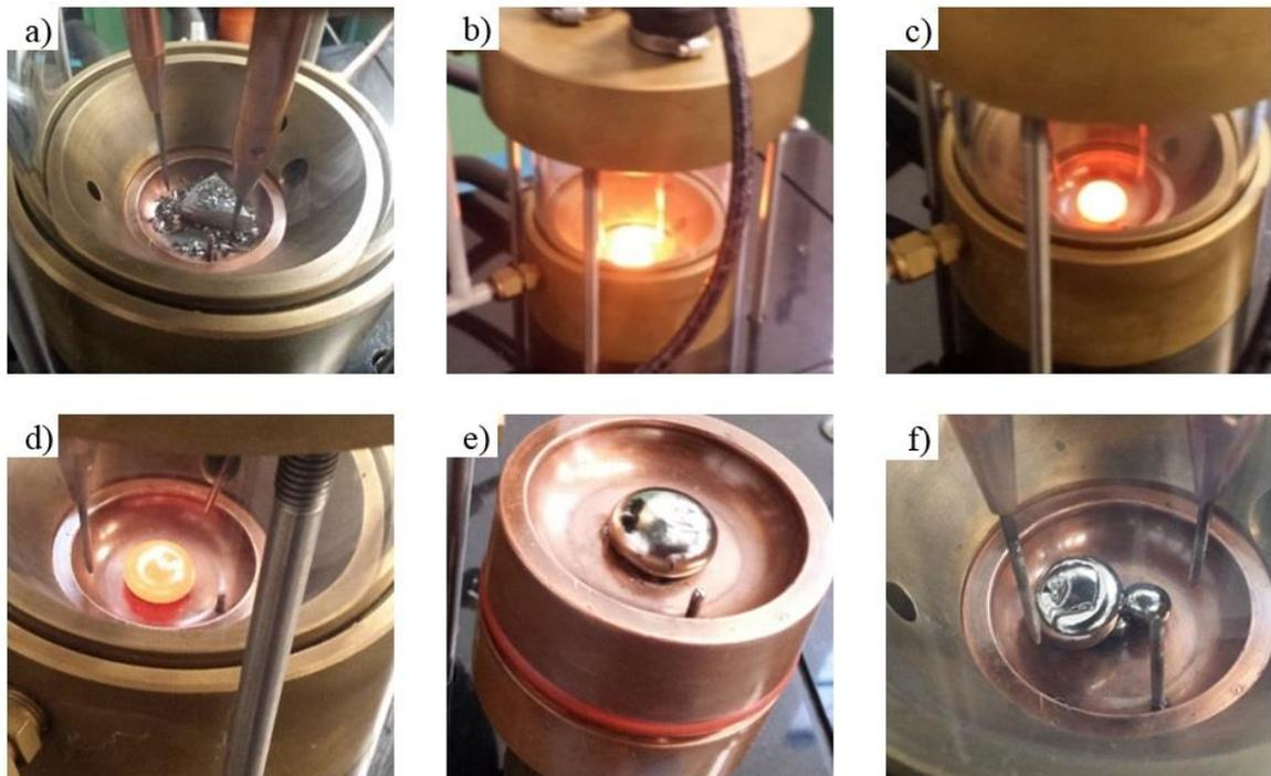
Figura 3-2. Proceso de fundición a) materias primas para obtener un botón de cada elemento de aleación b), c) y d) proceso de solidificación en crisol de Cu enfriado por agua e) botón final de cada elemento de aleación y f) unión de los diferentes botones de cada el elemento para obtener la aleación final.
