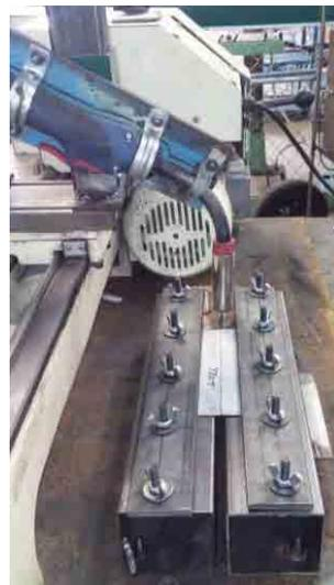
Figura 3-4 Sistema de sujeción mediante clamps hechos de acero.
