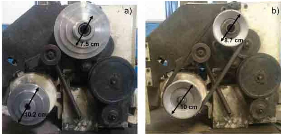
Figura 0-4 Cambio de poleas en donde a) presenta las poleas originales con una velocidad de avance de 0.83 cm/seg y b) Presenta las poleas adaptadas con una velocidad de avance de 0.73 cm/seg.
