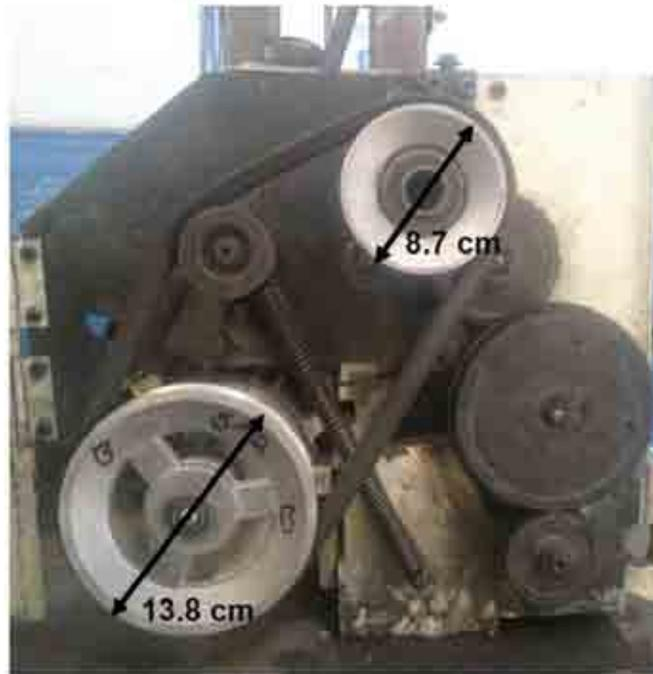
Figura 0-5 Segunda adaptación de poleas con una velocidad de avance de 0.96 cm/seg.
