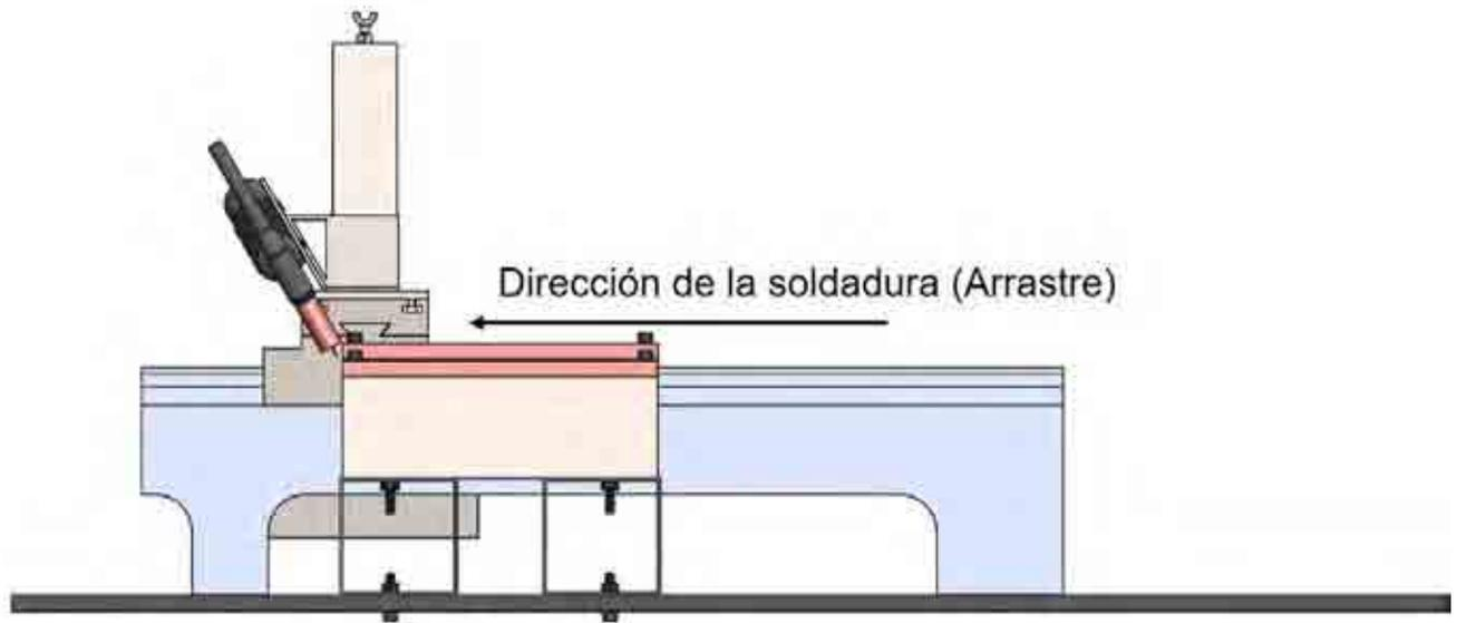
Figura 3-3 Dirección de avance de la antorcha durante el proceso de soldadura.
