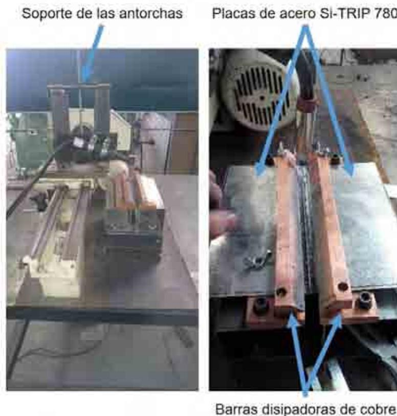
Figura 3-5 Implementación del diseño del equipo para la sujeción de láminas de acero Si-TRIP 780 y soporte de las antorchas para los procesos GTAW y GMAW.
