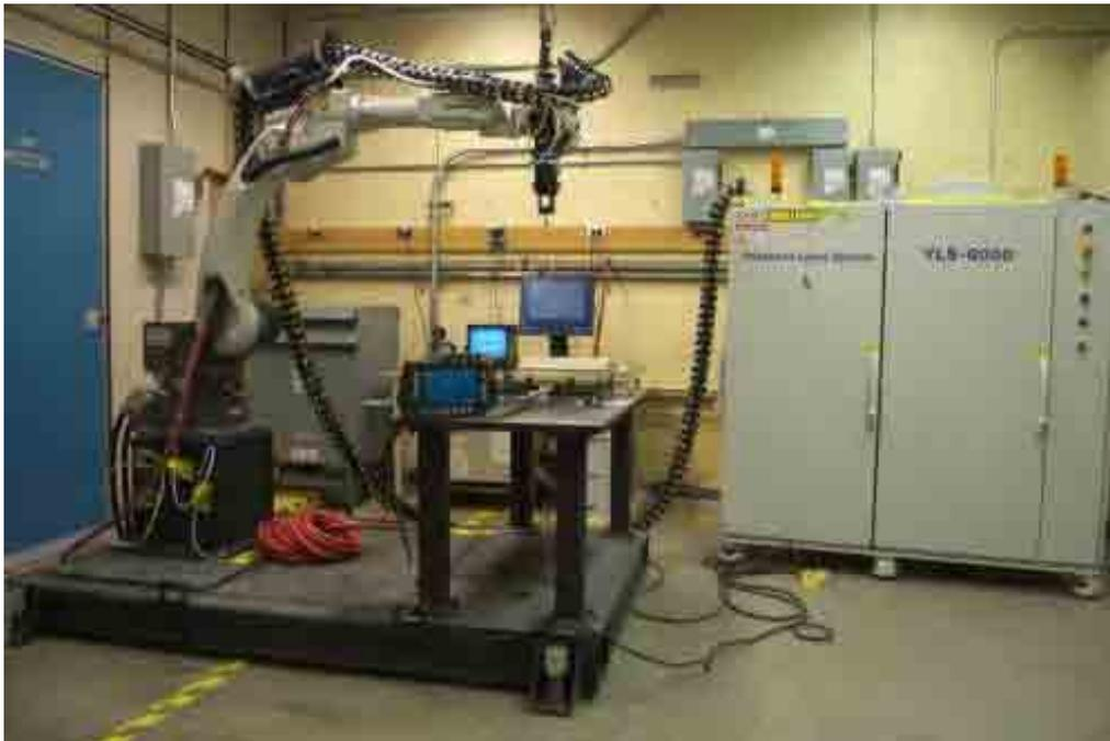
Figura 0-1 Maquina para soldadura laser de fibra óptica
