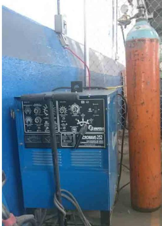
Figura 0-2 Equipo para soldar por GTAW
