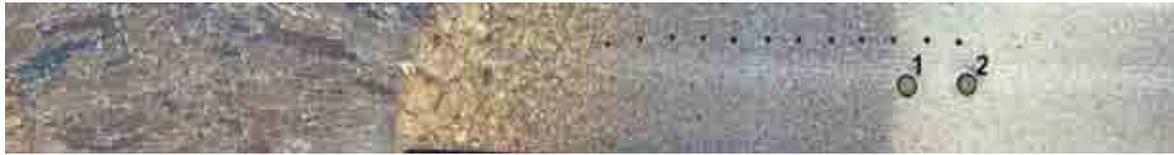
Figura 4-21 Indentaciones sobre la ZAT-SC de un acero Si-TRIP 780 soldado por GMAW.
