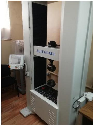
*Figura 3. 7 Equipo de ensayos de tensión uniaxial.*
