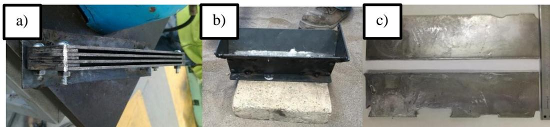
*Figura 3. 32 a) Construcción del molde a partir de placas de acero; b) Molde permanente con el embudo colocado, nótese que el material ya ha sido vaciado; c) Placas obtenidas a partir del molde.*
