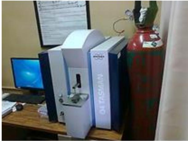
Figura 3. 5 Equipo de espectrometría de chispa.
