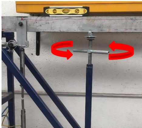
Figura 3. 23 Elevación del indentador.
