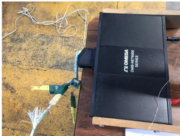
Figura 3. 12 Tarjeta de adquisición de datos Omega.
