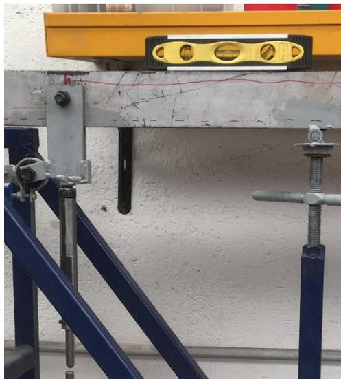
*Figura 3. 26 Nivel para el correcto posicionamiento del brazo.*
