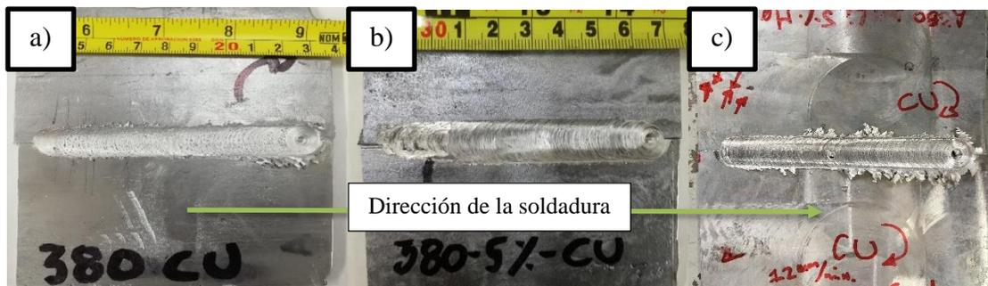
Figura 4. 10 Vista superior de las uniones soldadas por pin cuadrado. a) A380; b) A380 5Mg; c) A380 5Mg 1Li.
