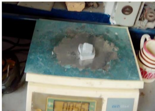
*Figura 3. 15 Corte en fragmentos de lingotes y obtención de peso.*
