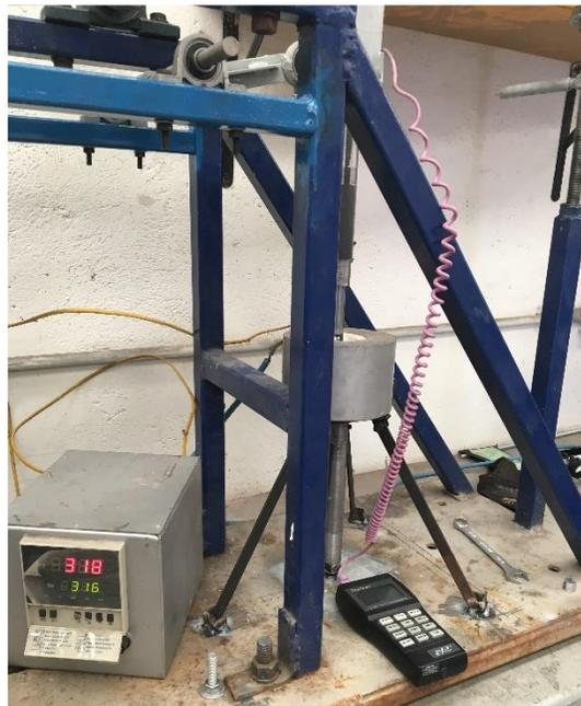
*Figura 3. 25 Control y verificación de la temperatura en la máquina de dureza.*
