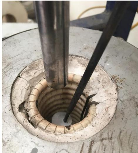
*Figura 3. 24 Colocación de las probetas de dureza.*
