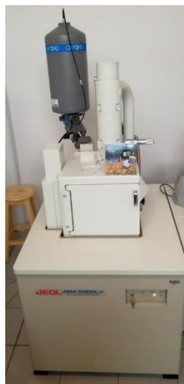
Figura 3. 14 Microscopio electrónico de barrido.
