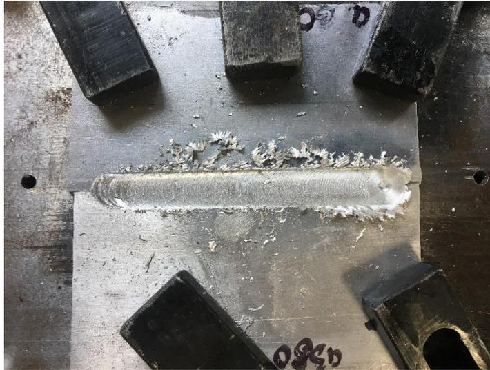
Figura 3. 38 Vista superior de la unión soldada.
