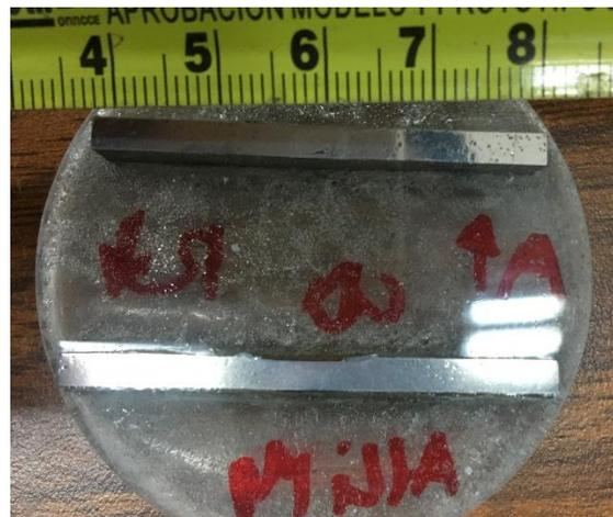
Figura 3. 42 Muestras encapsuladas y pulidas de la sección trasversal de la unión soldada.
