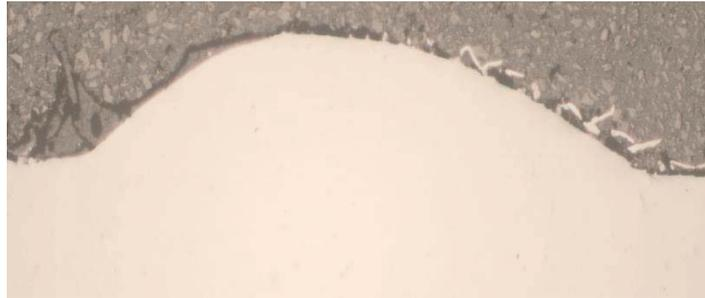
Figura 3.10. Sección transversal de un cordón para calcular su porosidad
