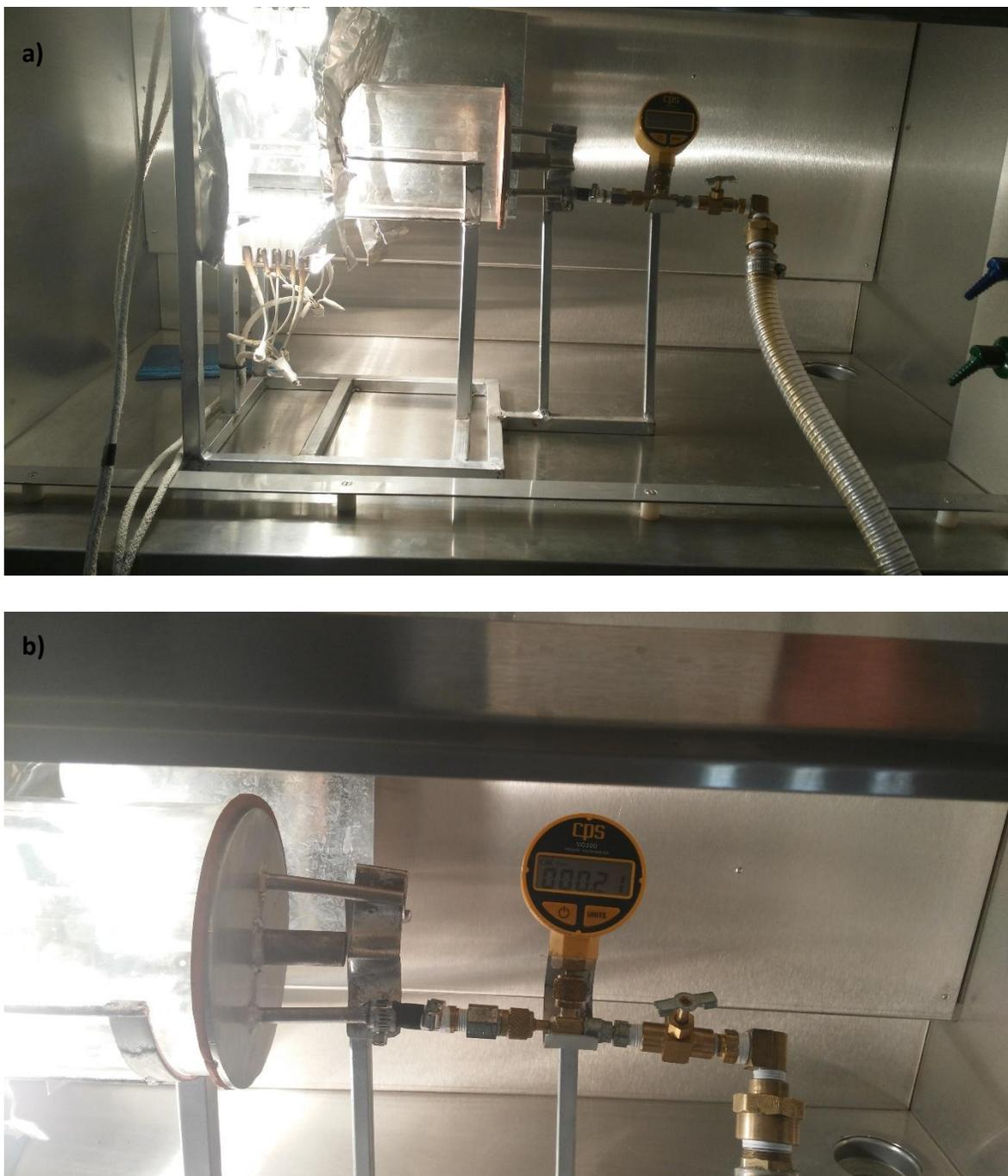
**Figura 4.11 Reactor de CSS. a)** Reactor de sublimación en funcionamiento. **b)** Reactor en función luego de 10 minutos de operación se observa una presión de 0.21 torr.
