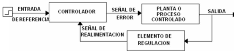
Figura 2.2 Diagrama general de un sistema de control en lazo cerrado.
