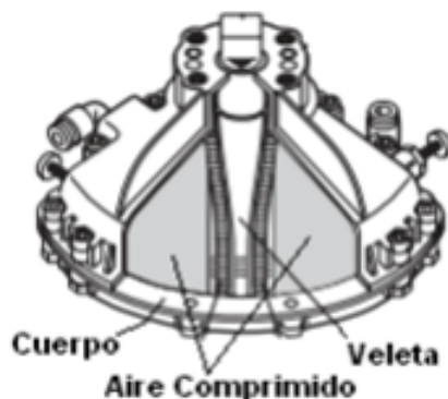
Figura 2.11 Funcionamiento del actuador neumático.
