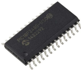
Figura 2.9: PIC 18f2480 contenido en el dispositivo ELM327.
