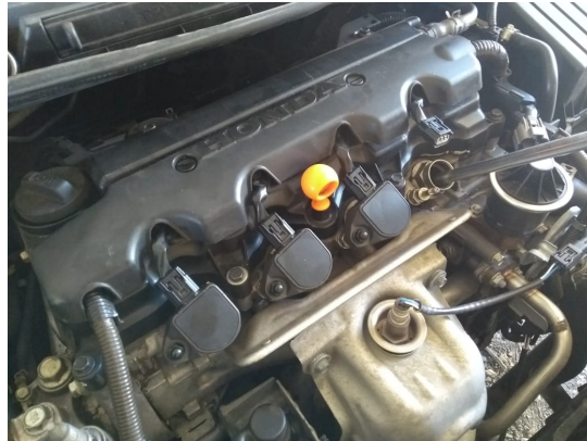
Figura 3.6: Cambio de primer bujía con una falla en cilindro 1.
