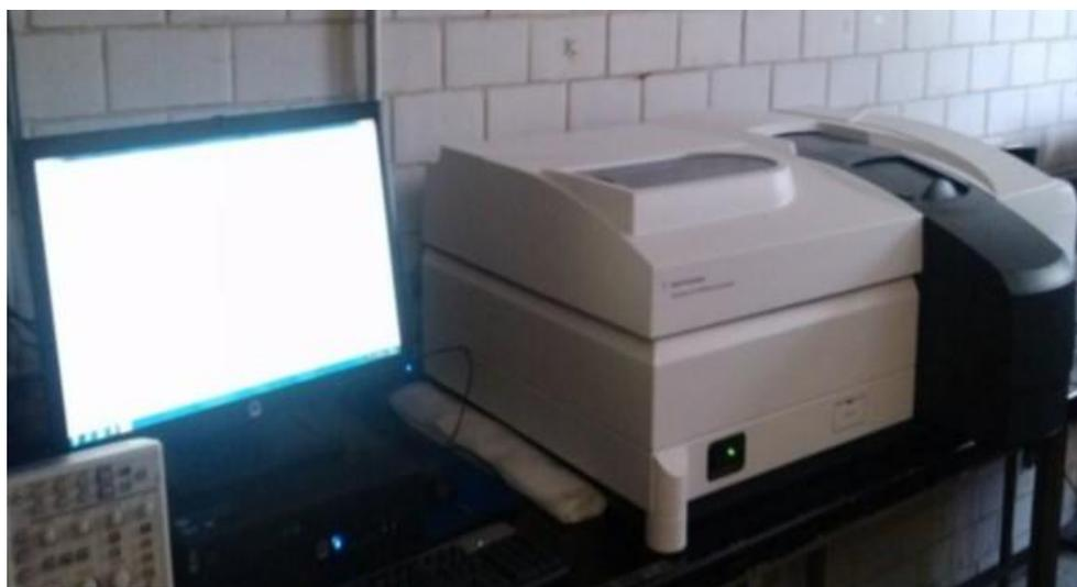
**Figura 4.2.** Equipo Agilent Cary 5000 para realizar espectroscopia de reflectancia difusa.
