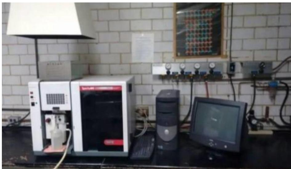
*Figura 4.3. Espectrofotómetro SpectrAA Varian 220 FS para determinar la cantidad de Paladio.*
