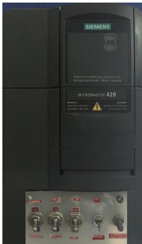
El control manual es una acción que ejecuta el usuario desde el equipo de cómputo únicamente para activarlo ó desde los interruptores. La función de los interruptores es encender, cambiar el sentido del giro y detectar presencia de fallas en el sistema y mediante un potenciómetro se varia la señal de consigna que se envía al variador para aumentar o disminuir la velocidad del ventilador. El panel de control se muestra en la figura #1.
